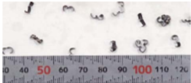
Butzenbildung im Zentrum: \varnothing 1.42 mm, Rz: 0.015 mm
